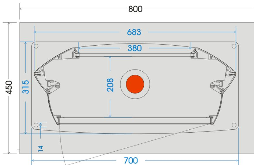
Massif béton dosé à 350 Kg/m<sup>3</sup>
